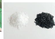
押出機でリサイクルペレットへ
